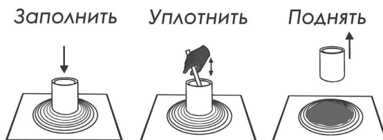
Рис. 9. Оценка консистенции смеси для набрызга по методике Power-Sprays
