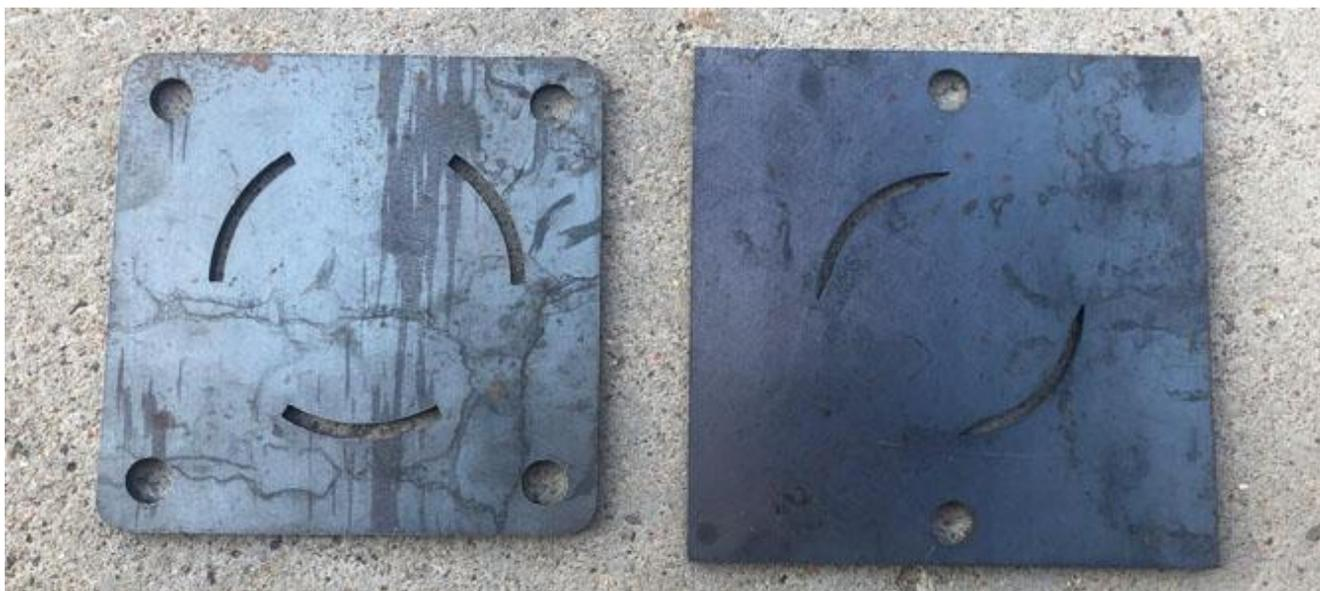
Оголовок выполнен в виде пластины с прорезью. Такое простое решение позволяет ускорить и упростить монтаж. И уже не имеет значение, насколько заглублена свая. Это потому, что оголовок не надевается на сваю а укладывается сверху на её торец. Всё, что нужно — это совместить прорезь либо с контуром торца либо с выступающей закладной.
