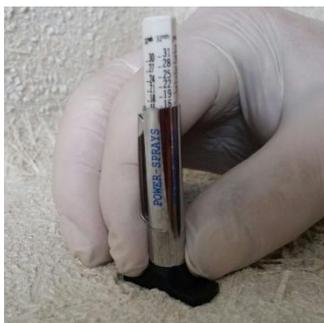
Чтобы определить толщину слоя СФБ сразу после набрызга, удобно использовать инструмент, который рекомендует компания Power-Sprays:
